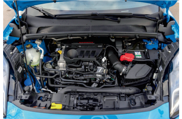
Niet de 1.5 uit de ST met handbak, maar een opgevoerde 1.0 EcoBoost.
