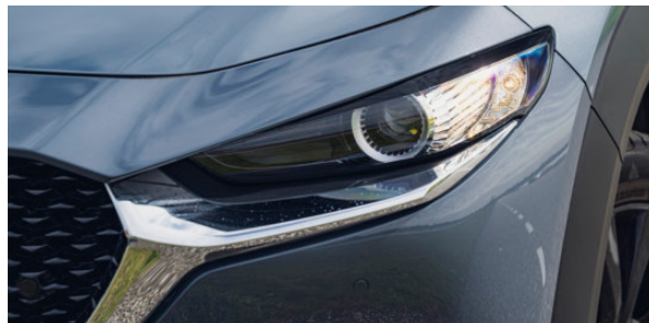
▲ Vrij traditionele tellers, maar toch oogt dit instrumentarium niet ouderwets. ▼ Led-koplampen zijn standaard op de Mazda, maar worden bij eenvoudiger uitvoeringen gecombineerd met halogeen-dagrijlampen.
