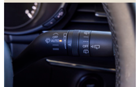
▲ Led-dimlicht, maar halogeen dagrijverlichting. Dat zien we niet meer zo vaak. ▼ Klein handigheidje: als de regensensor actief is, brandt er een lampje op de hendel.
